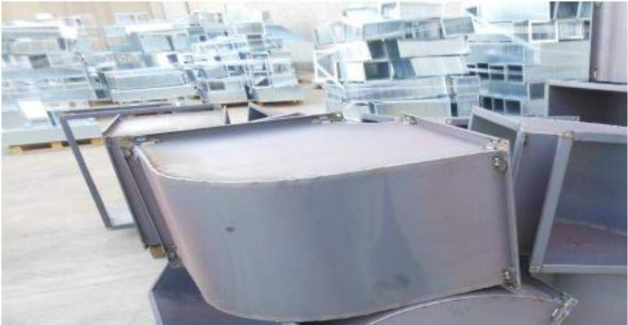
Figura 14 – Canali e raccordi in lamiera nera di tipo saldato
