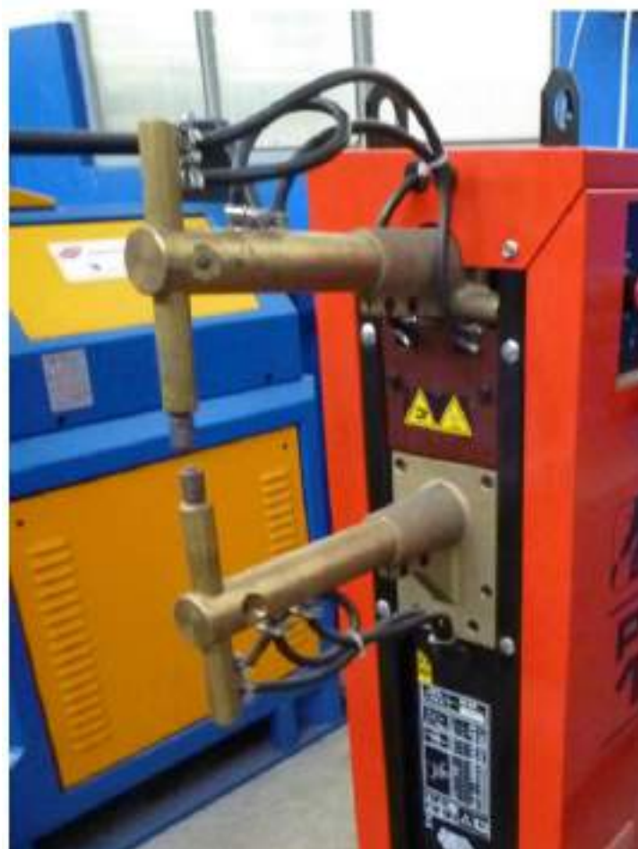
Figura 9 – Elettropuntatrice: serve per unire due o più lamiere mediante elettrofusione
