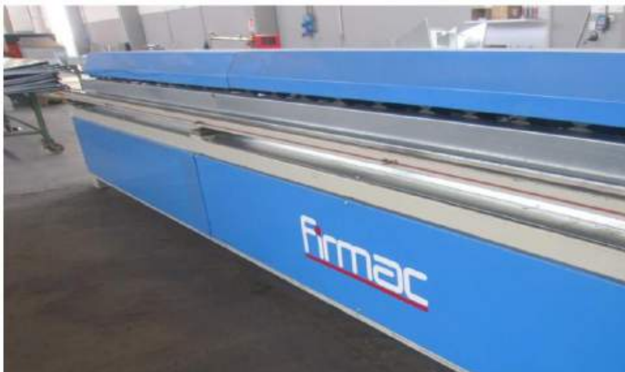
Figura 6 – Macchina per ricavare flange direttamente dalla lamiera
