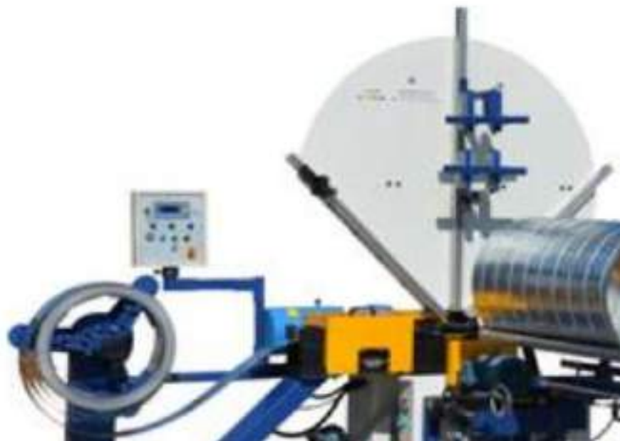
Figura 8 – Macchina per formazione tubazione spiroidale partendo da nastri in lamiera zincata o inox
