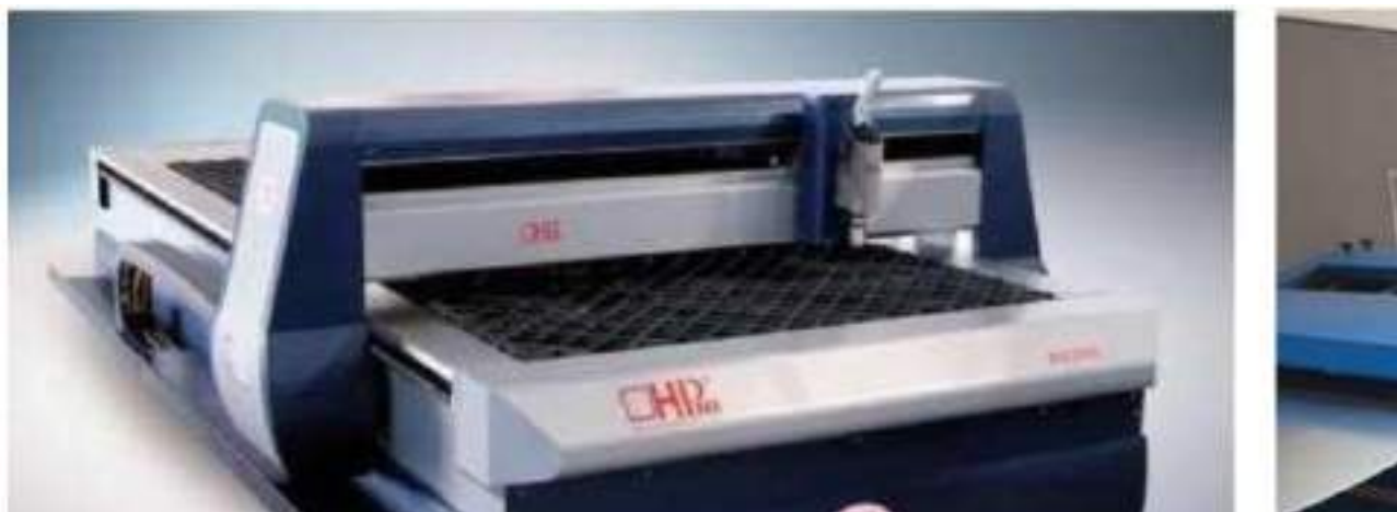
Figura 5 – Macchina taglio plasma e relativo caricatore di coils, serve per il taglio di tutti i pezzi speciali rettangolari e circolari.
