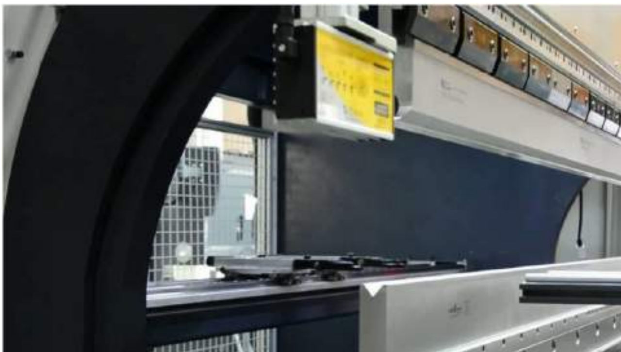
Figura 7 – Pressa piegatrice che serve a formare delle pieghe sulla lamiera ad angolazioni variabili mediante controllo numerico.
